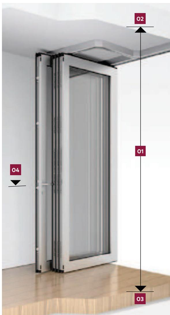
Die Anlagenhöhe wird immer von der Oberkante des fertigen Fußbodens (OKFF) bis zur Oberkante der Laufschiene angegeben.
