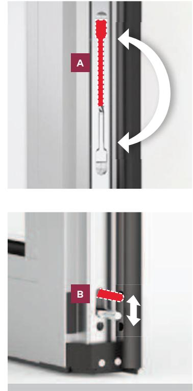
Im geschlossenen Zustand werden die Schiebeflügel über die Verriegelung in den Bodenhülsen fixiert. Der Wechsel zwischen Stand- und Schiebe-funktion erfolgt durch einfache Riegelbedien-ung, entweder als Kantriegel (**A**) oder Stirnfeststeller (**B**).
